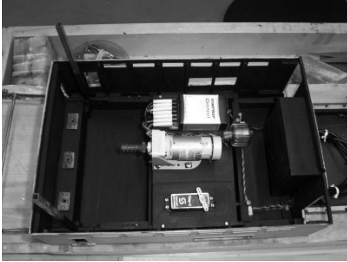
Einbau der RC Komponenten, Antrieb mit Getriebemotor.
