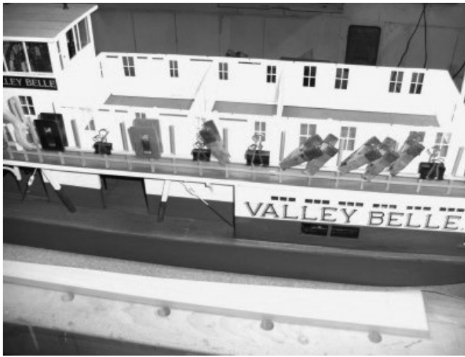
Das Geländer wird immer wieder an den Decksprung angepasst, dann erst fertig gebaut und lackiert.
