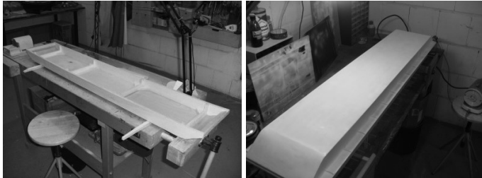
Rumpf Rohbau, grundiert und gespachtelt.
