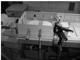
Die Außenwände des Maindeck Aufbaus werden errichtet.
